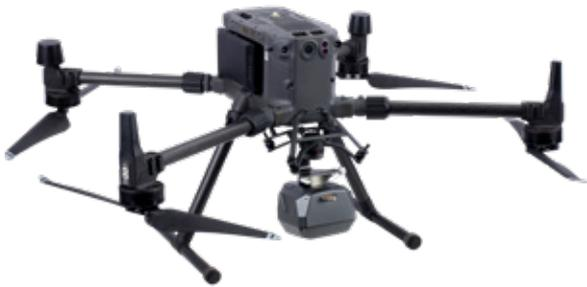
**DJI M300 RTK + C30 (velocidad de vuelo 8 m/s, batería nueva)**
